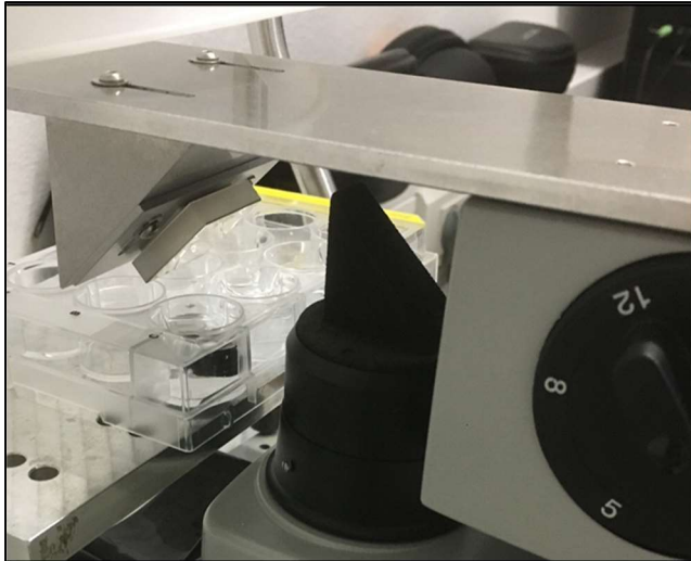
Abbildung 7: Laserbehandlung der Organkulturen. Die Präparate wurden in einer 12-Well-Platte mithilfe einer Spiegelapparatur unter der Spaltlampe gelasert. Die Integrität des Retinalen Pigmentepithels (RPE) wurde zuvor an der Spaltlampe überprüft.
